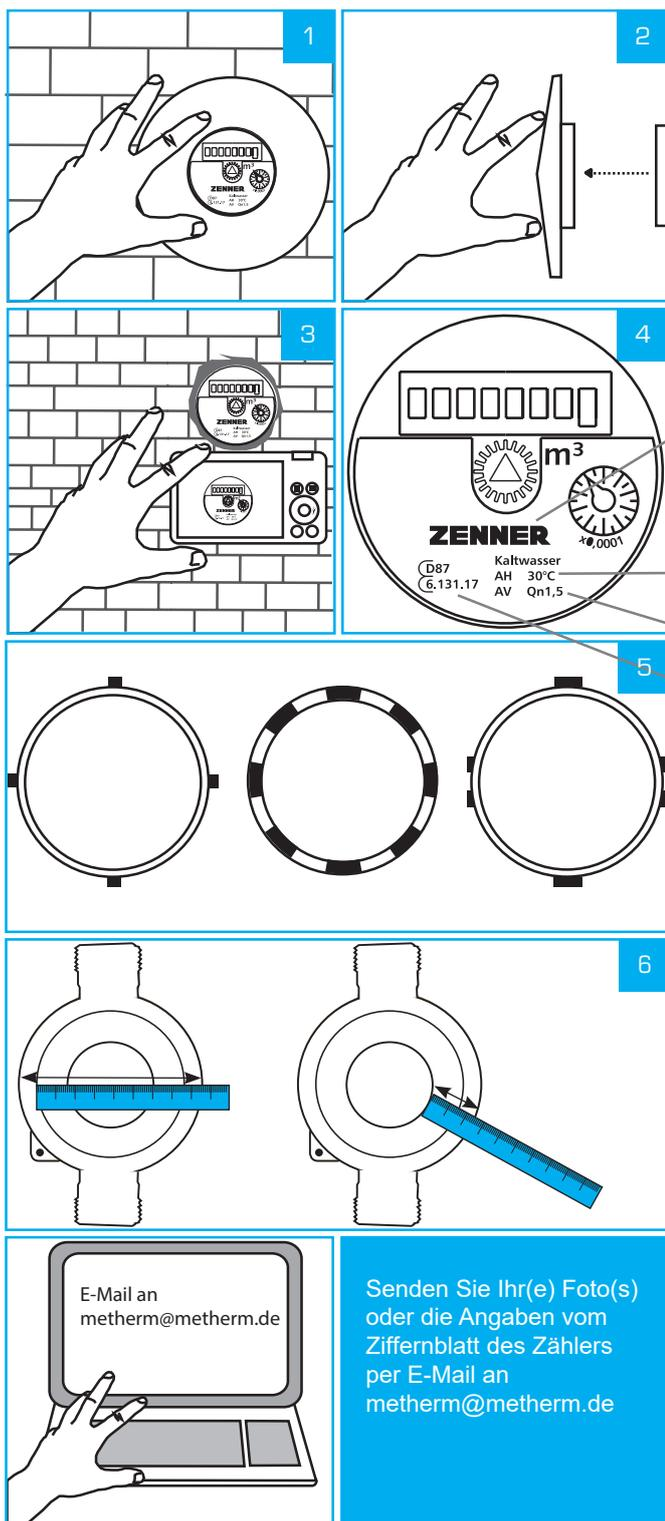
Ziehen Sie die Rosette des Zählers ab, so dass der Zähler freiliegt (Abb. 1 + 2).
